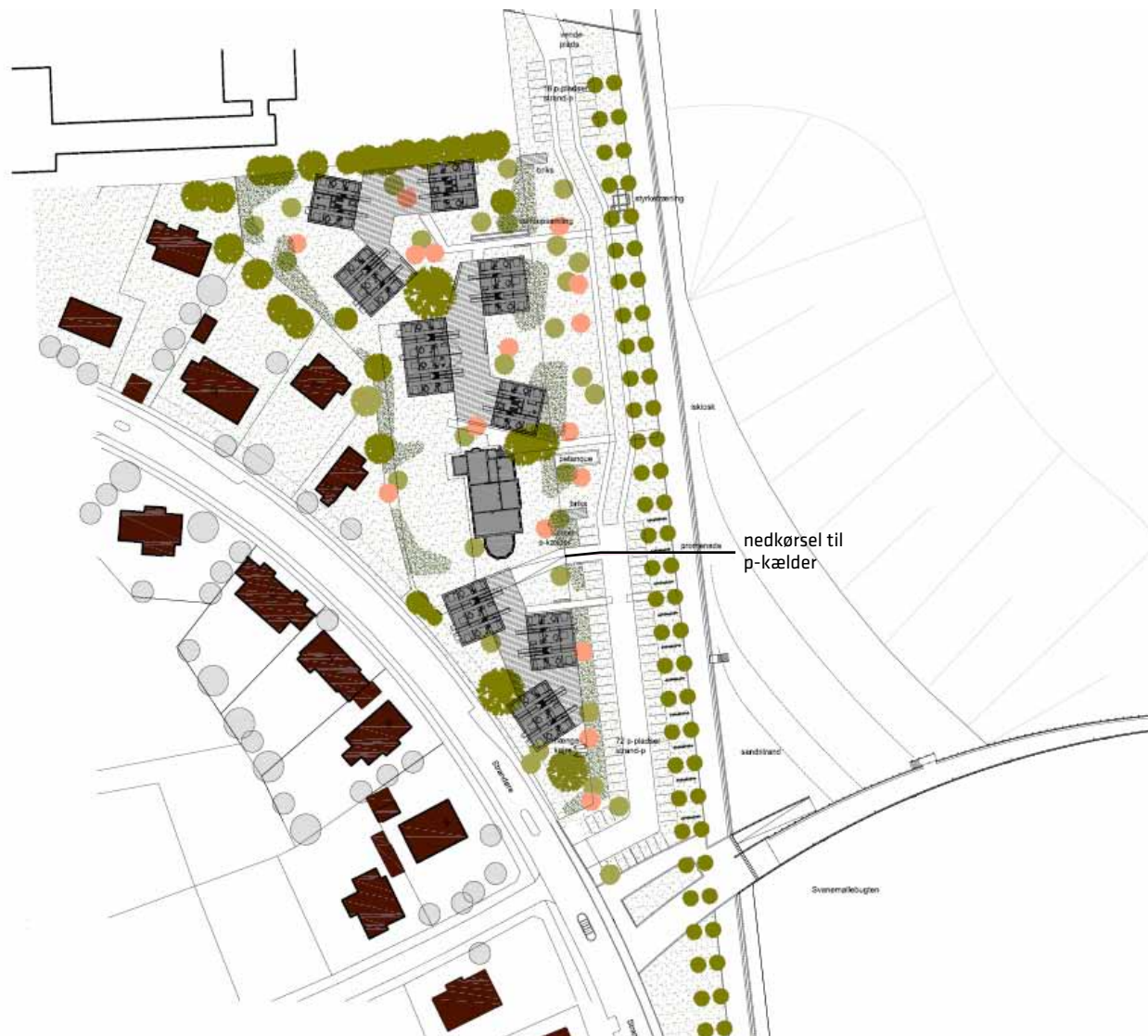
Situationsplan uden vognport. Uden vognport er der mulighed for at placere nedkørsel til p-kælder syd for den bevarede villa og dermed skabe et mere fredeliggjort areal nord for.
