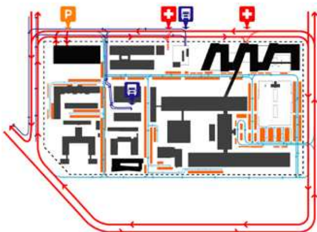
Rigshospitalsområdet serviceres af et overordnet eksternt 'loop', og to indre loops, som øger overskueligheden over p-området for den parkeringssøgende og giver maksimal flow. Illustration fra vinderprojekt.
