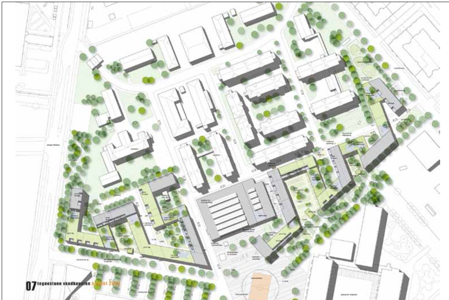
Plan af Vandkunstens forslag, som er udformet som en perforeret boligslange, der danner forskellige rum.
