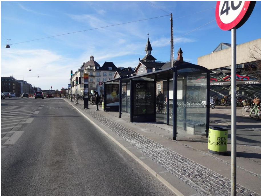
Figur 11 Eksempel på bred busperron, hvor læskærm mm er placeret på perronen (Oslo Plads)
