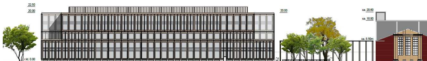
Facader mod Scandiagade. Illustrationen viser et eksempel på et nybyggeri mod Scandiagade i overensstemmelse med tillægget. Til venstre ses nybyggeriet og til højre det eksisterende parkeringshus. En pergolakonstruktion binder de to byggerier sammen og afgrænser 'Den grønne Kile' mod Scandiagade. I pergolaen er der integreret en støjskærm i glas. Adgang til 'Den grønne Kile' sker gennem en sluse i glasskærmen. Mod gaden er der cykelparkering og træer. Illustration: entasis.
