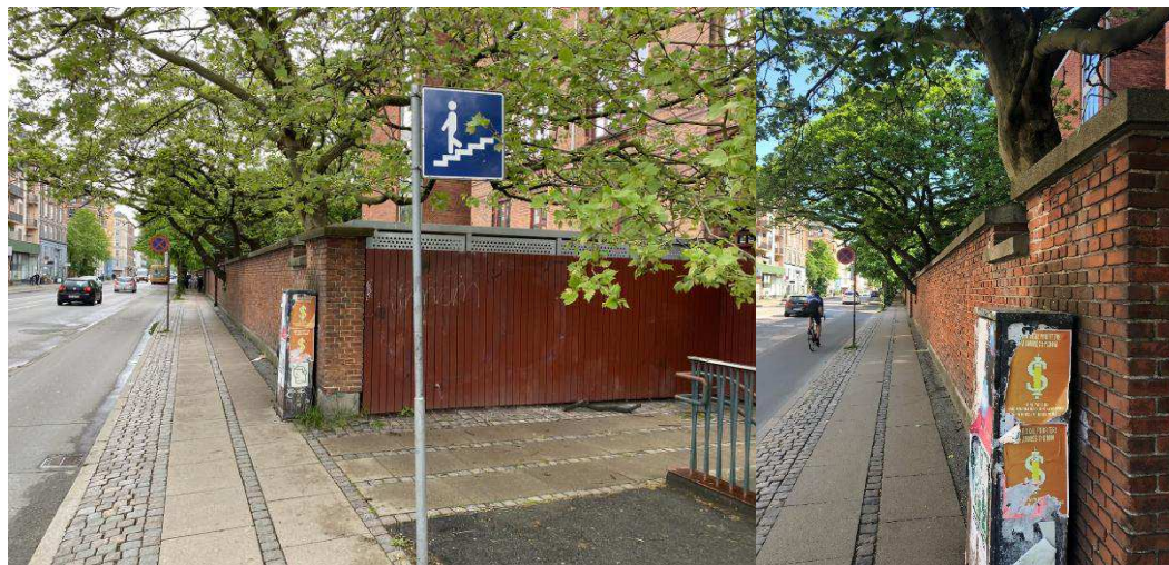
Figur 2. Placering af NO x måler på Jagtvej. Der suges luft ind af metalrøret over muren.
