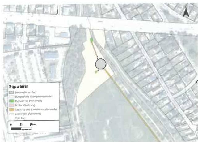
Forventet placering af bassin og bygværker ved UH12 (Jyllingevej) og bassinledning fra UH11.
