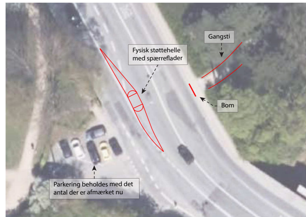
Figur 5-13 // Principskitse af forslag til etablering af en støttehelle ved gangstikrydsningen af Jernbane Allé. Hellen er placeret på stedet og derfor må fodgængere til/fra stien mod nord gå en kort strækning på fortovet for at komme til den forbedrede krydsning. Stiens møde med Jernbane Allé fra nord kan flyttes, men det er ikke umiddelbart nødvendigt. Begrundelsen for at stien forskydes ved krydsningen er at fodgængerne ikke skal gå direkte ud på vejen, for at fodgænerkrydsningen ikke slutter midt i parkeringsområdet, samt for at undgå at fjerne en del af hækken. Denne udformning gælder kun scenarie 3 hvor der ikke er cyklister der skal krydse. Ved scenarie 1 er stien og dermed støttehellen bredere.
