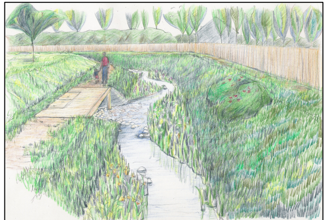
Figur 18: Løsning med udløb under spang
