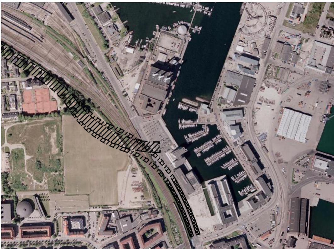
Figur 4.16; Forslag 3 - Linieføring fra Svanemølle baneanlæg til kryds mellem Kalkbrænderihavnsvej og Sundkrogsgade (dobbelt skraveret er vej i terræn, enkeltskraveret er vej i tunnel)
