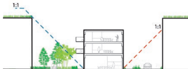
Fig. 6.2. jf. stk. 3. Illustrationen viser at højdegrænsplanet på 1:1 overholdes mod en side i forhold til bygningen i midten
