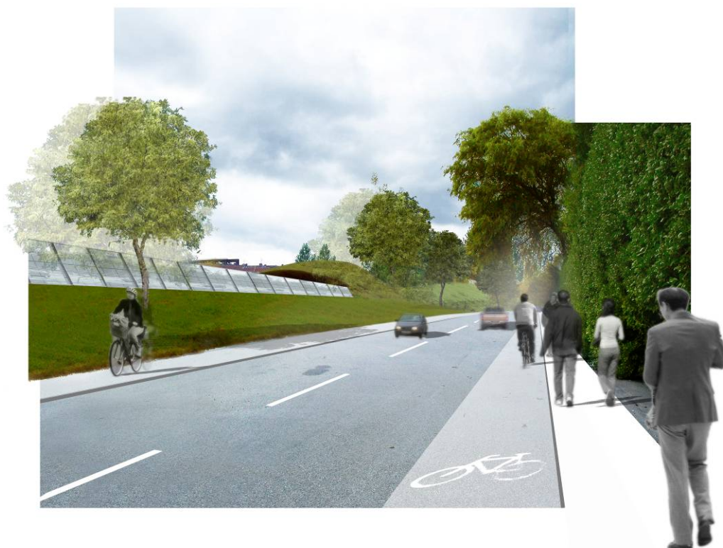
Figur 12.1 Eksempel på støjafskærmning med jordvold hvorpå der er placeret støjskærm (ved Strandvænget) Schönherr Landskab 2008 .
