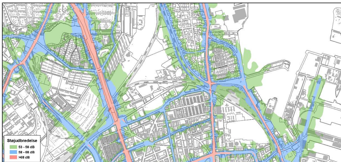
Figur 9.3 Støjbredelse basissituation – Beregnet med den trafikbelastning, der forventes i 2018 (uden Nordhavnsvej).
