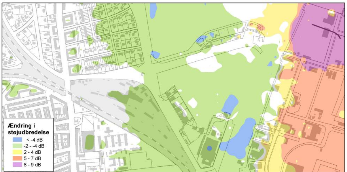
Figur 133.4B Ændring i trafikstøj i 1,5 meters højde over terræn, i forhold til Basissituationen uden Nordhavnsvej
