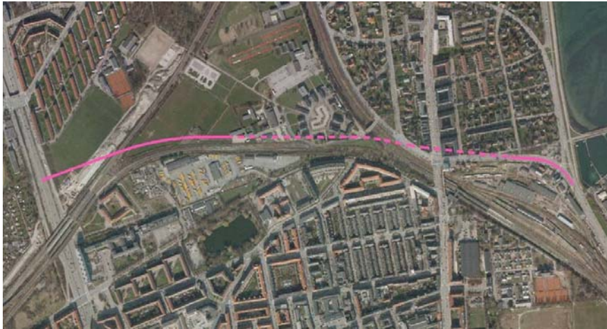
Figur 7.4 Linieføring for Vejforslag A1-4. Passagen under Nordbanen/Kystbane og Strandvejen udføres som en boret tunnel. Vejstrækning i tunnel er stiplet, vejstrækning i terræn er fuldt optrukket.
