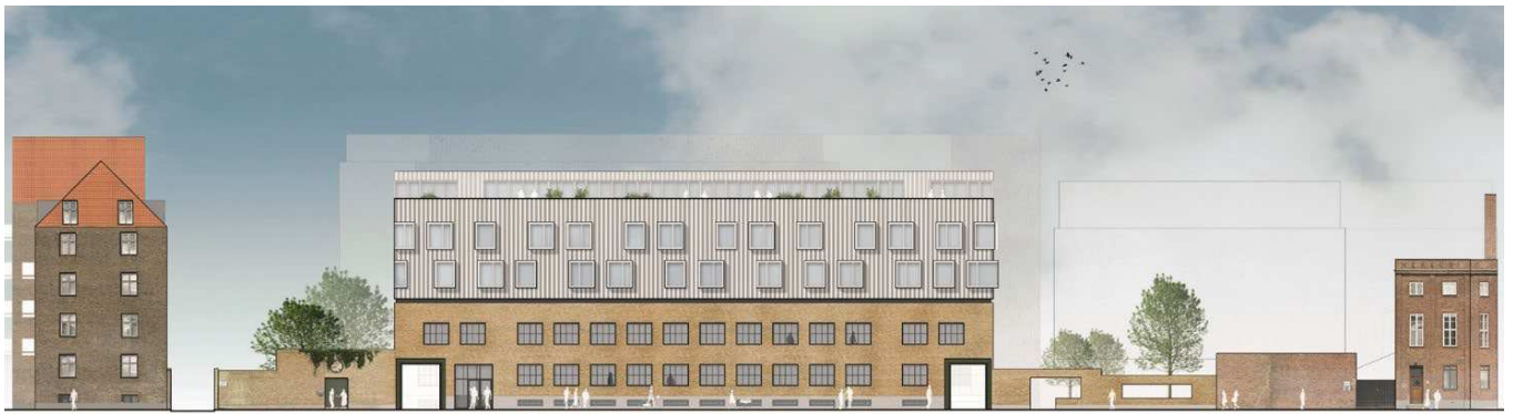
Facade mod Hermodsgade. Opstalten viser et eksempel på nybyggeri, som det vil blive oplevet. Facader er beklædt med lodrette, rektangulære lameller. Lamelbeklædning er vist som en signatur. Illustration: Steen Palsbøll Arkitekter m.a.a.
