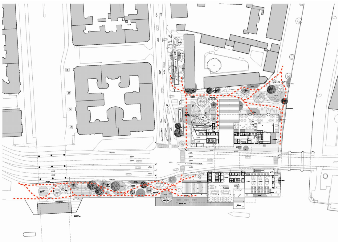
Figur 4-10 Situationsplan over projektområdet, med Vester Voldgade og ned- og opkørsel til parkeringsanlæg, lukning af Bryghusgade og byrum. Kilde: OMA og K&B, maj 2008.
