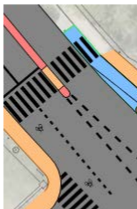
Figur 2-6 Placering af fodgængerovergang. Udsnit fra tegning A116096-038_Tegn-002.
