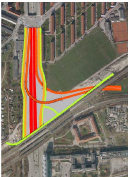
Figur 4.4 Forslag I til tilslutningsanlæg ved Helsingørmotorvejen: Niveaufrie ramper mellem Helsingørmotorvejen og Nordhavnsvej. Rød: Helsingørmotorvejen, Orange: Nordhavnsvej, Gul: Lyngbyvej, Grøn: Fortov og cykelsti.
