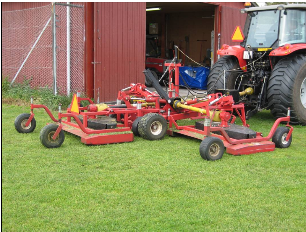
Figur 3. Kløvermarkens traktortrukne rotorklipper til græsslåning.
