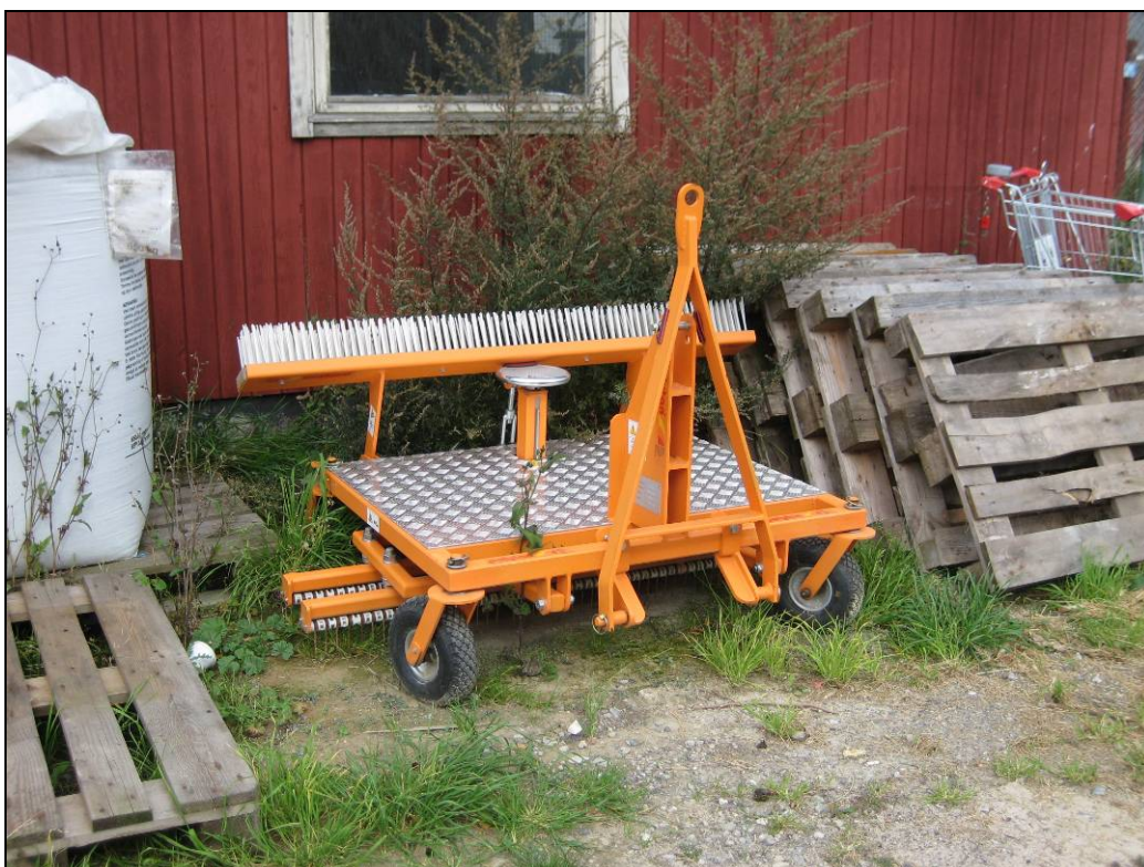
Figur 4. Udstyr til vedligeholdelse af kunstgræsbaner. Redskabet monteres på en lille traktor eller tilsvarende.
