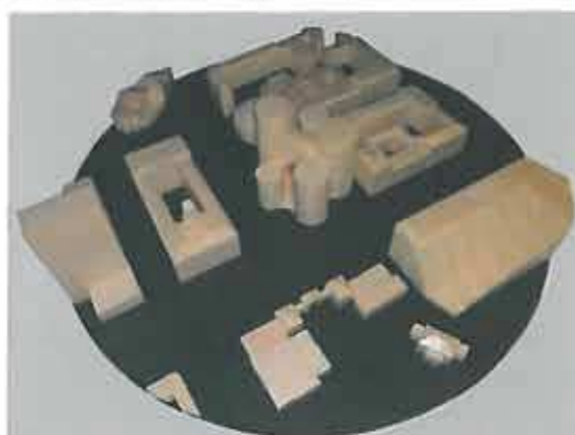
Figur 1.1. Vindtunnelmodel af Axeltorv samt nabobebyggelse.
