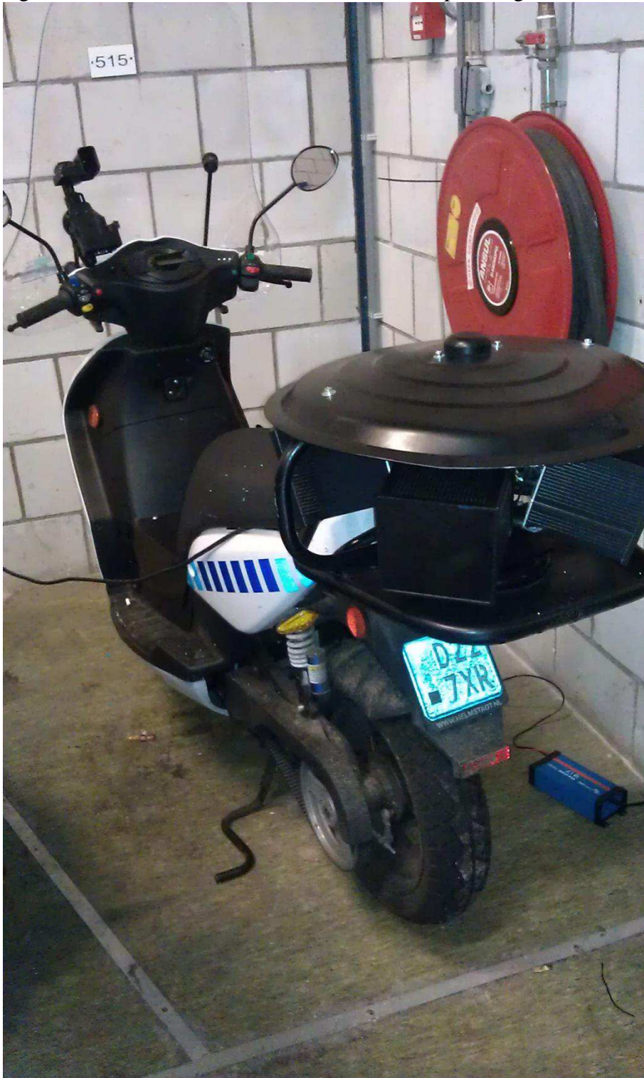
Figur 3: Scanscooter med 2 kameraer + trådløs opkobling via terminal
