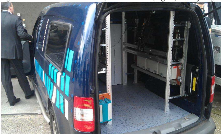
Figur 1: Scancar med 6 kameraer, IT-installation, og strømforsyning
