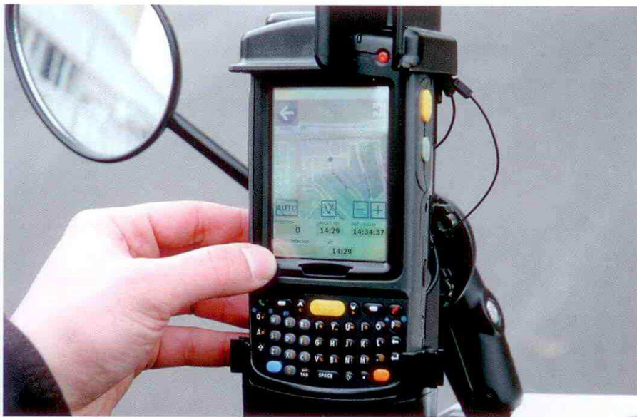
Figur 5: Parkeringskontrol vha. håndterminal med input fra Scancar
