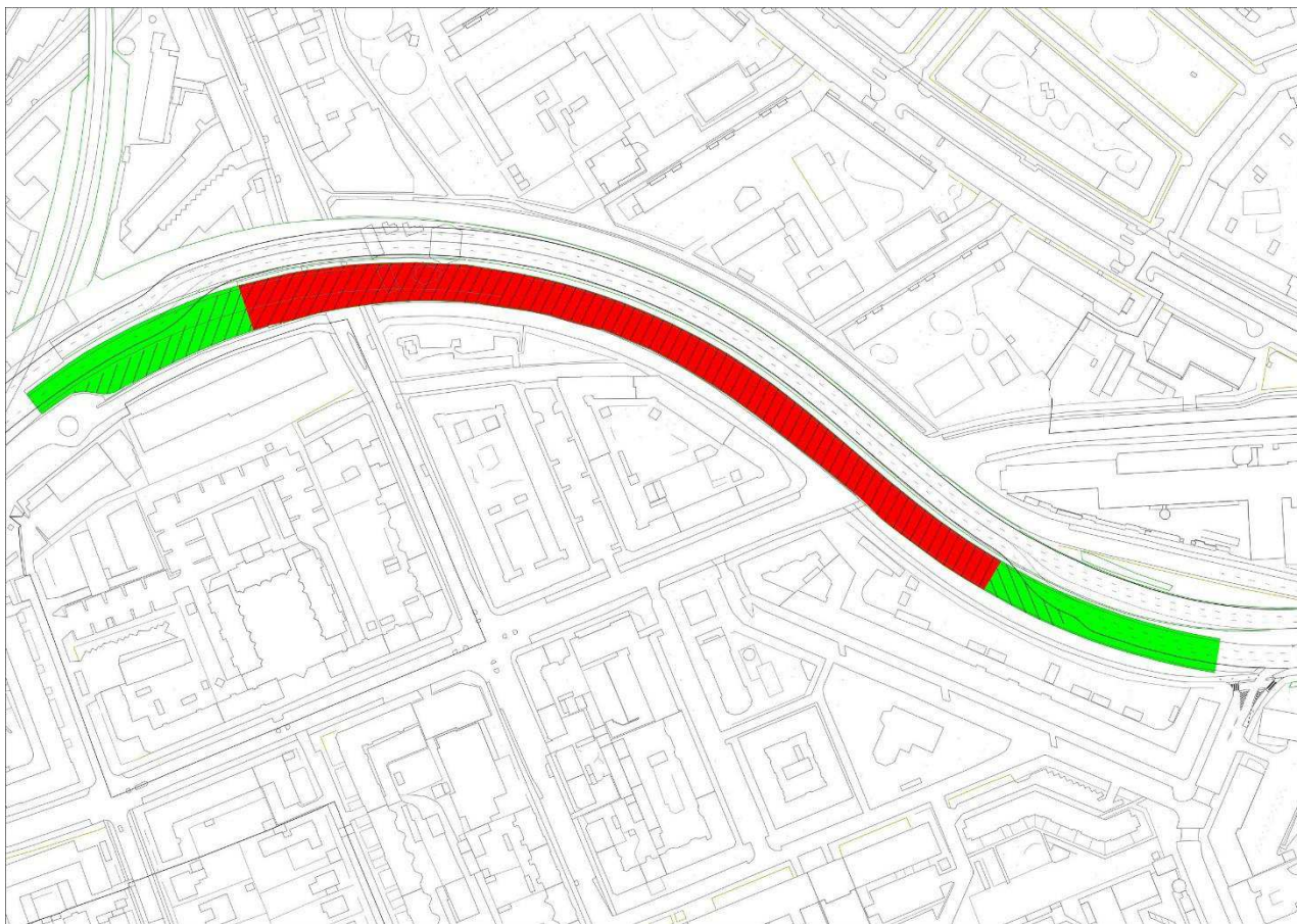
Figur 5 Principskitse for overgang fra tre til to spor samt overledning ved jernbanen. Den røde markering er den del af Bispeengbuen, der står på søjler og dermed fjernes.
