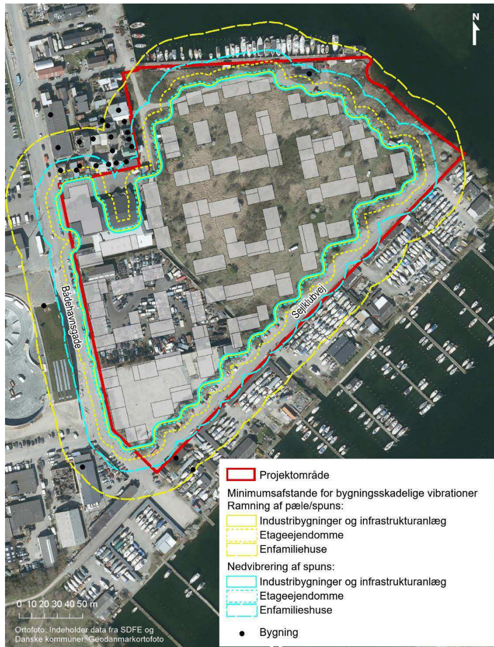
Figur 10-1 Udbredelseskort fra vibrationer fra henholdsvis ramning af pæle/spuns og fra vibrering af spuns.
