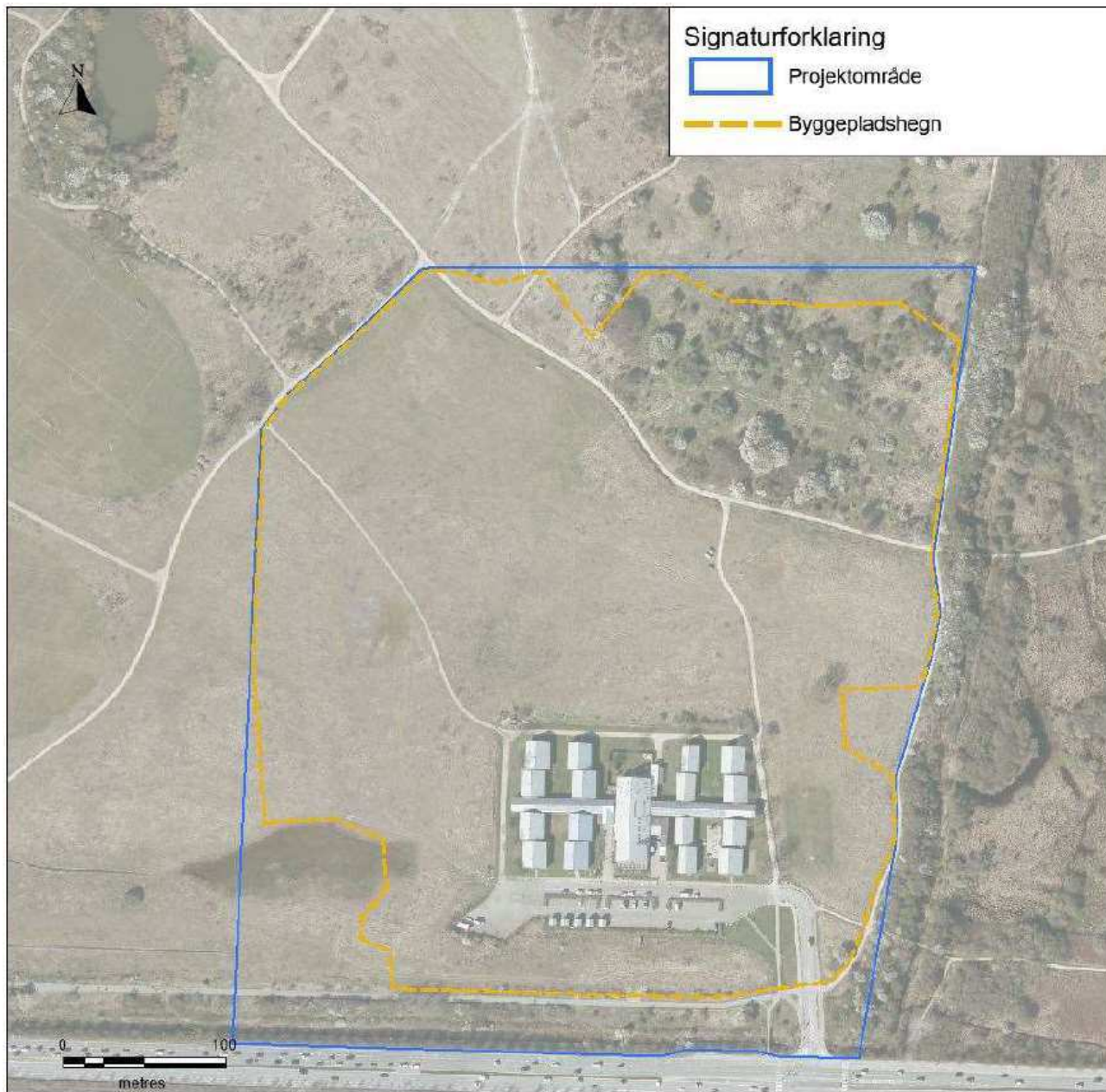
Figur 5.4 Projekt- og lokalplanafrænsning, hvor der opstilles byggepladshegn i den indledende fase.
