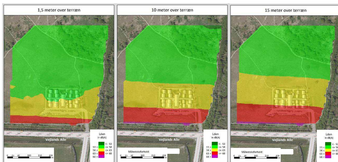
Figur 9.2. Resultat af vejledende støjberegning. Støjkortene viser støjudbredelsen i 3 højder over eksisterende terræn: 1,5 m, 10 m og 15 m.
