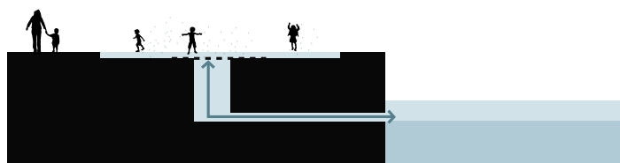
6.15 Vandspejl Basinforsinkelse (regnvand) og behandling af havnevand
