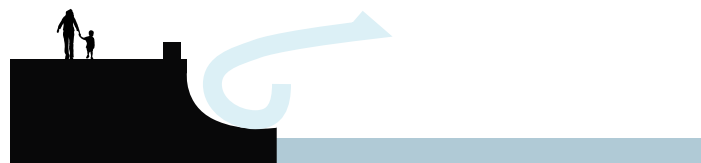
4.20 Havnekanten som vindbreaker
