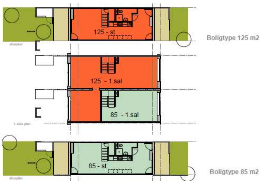
Boliger i 2 etager på henholdsvis 85 m 2 og 125 m 2 .
