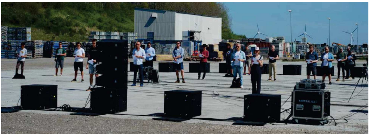
Figur 4 - Refshaleøen test [2]. På billede ses fire af de primære subwoofere i forgrunden, samt en række af de sekundære subwoofere i baggrunden. I forgrunden er også fire almindelige højtalere i et line array stablet oven på den ene subwoofer. Deres formål er ikke beskrevet i [2].
