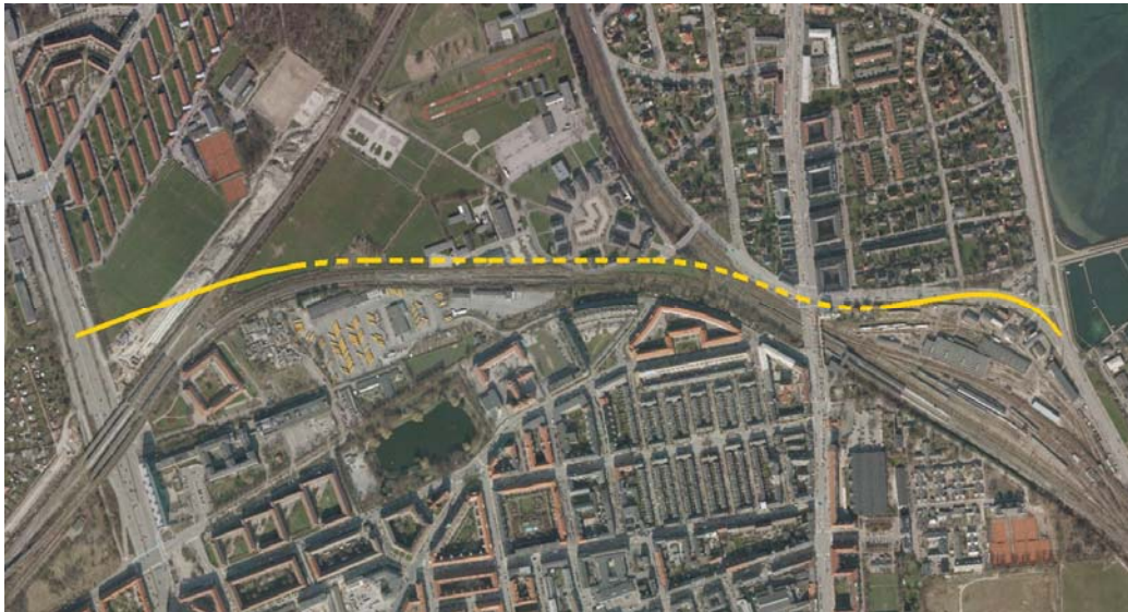
Figur 5.2 Linieføring for Vejforslag A1-1. Tunnelstrækning forlænget ca. 375 mod vest. Vejstrækning i tunnel er stiplede, vejstrækning i terræn er fuldt optrukket.
