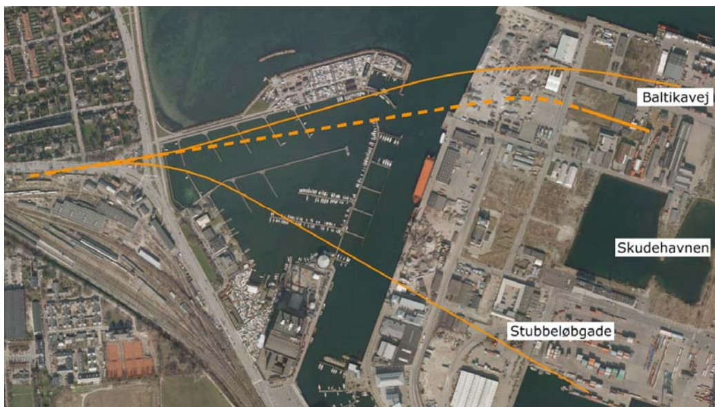
Figur 6.1 Forslag til linieføring for Vejforslag A2. Vejstrækning i tunnel er stipt, vejstrækning i terræn er fuldt optrukket. Tynde linier angiver område for mulige linieføringer.
