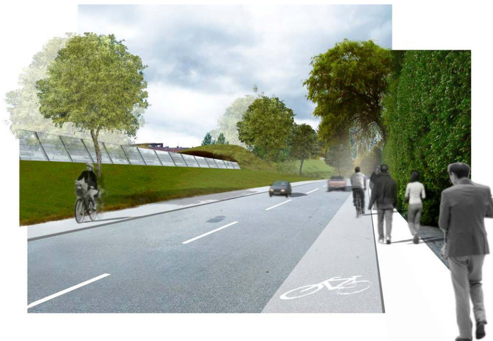
Figur 12.1 Eksempel på støjafskærmning med jordvold hvorpå der er placeret støjskærm (ved Strandvænget) Schönherr Landskab 2008 .
