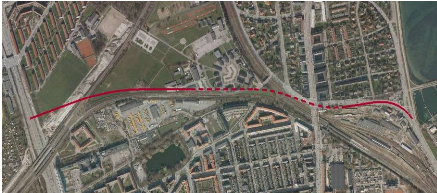
Figur 4.9 Linieføring for Vejforslag A1. Vejstrækning i tunnel er stiplet, vejstrækning i terræn er fuldt optrukket.
