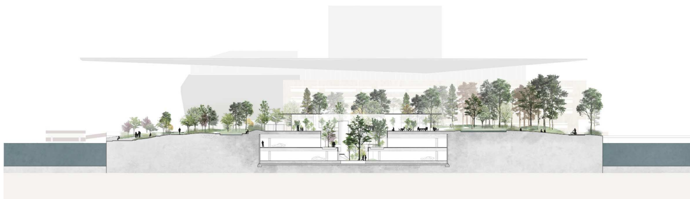
Visualisering, der viser forslag til snit gennem parken, cafébygningen og parkeringskælderen, set fra syd. Terrænbearbejdning og store træer skal sikre volumen i parken, så den rumlige balance omkring Operaen opretholdes, og så oplevelsen af den store bygning mildnes. De indvendige bygningsforhold med den vertikale forbindelse mellem cafébygningen og parkeringskælderen er ikke omfattet af lokalplanen. Illustration: COBE.
