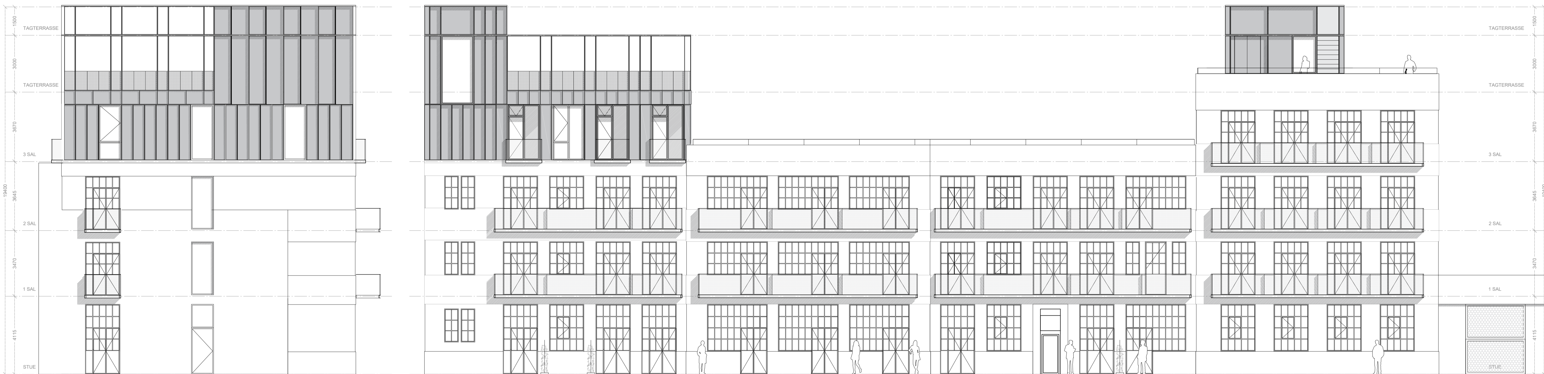
Gavl mod Strædet (Syd) Indgang Vindue tilføj Facade mod Rådmandsgade (Øst) Placering af eks. hoveddør bevarer Nuværende port lukkes Ny port
