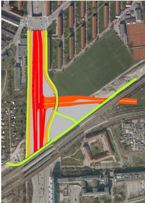
Figur 4.6 Forslag III til tilslutningsanlæg ved Helsingørmotorvejen: signalanlæg mellem Nordhavnsvej og Helsingørmotorvejen. Rød: Helsingørmotorvejen, Orange: Nordhavnsvej, Gul: Lyngbyvej, Grøn: Fortov og cykelsti.
