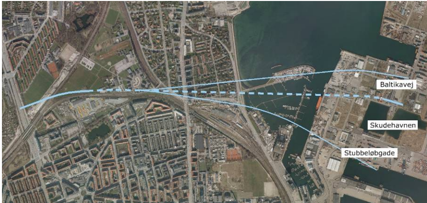
Figur 4.15 Forslag til linjeføring for Vejforslag B. Vejstrækning i tunnel er stiptet, vejstrækning i terræn er fuldt optrukket. De nordlige og sydlige linjer angiver område for mulige linjeføringer.
