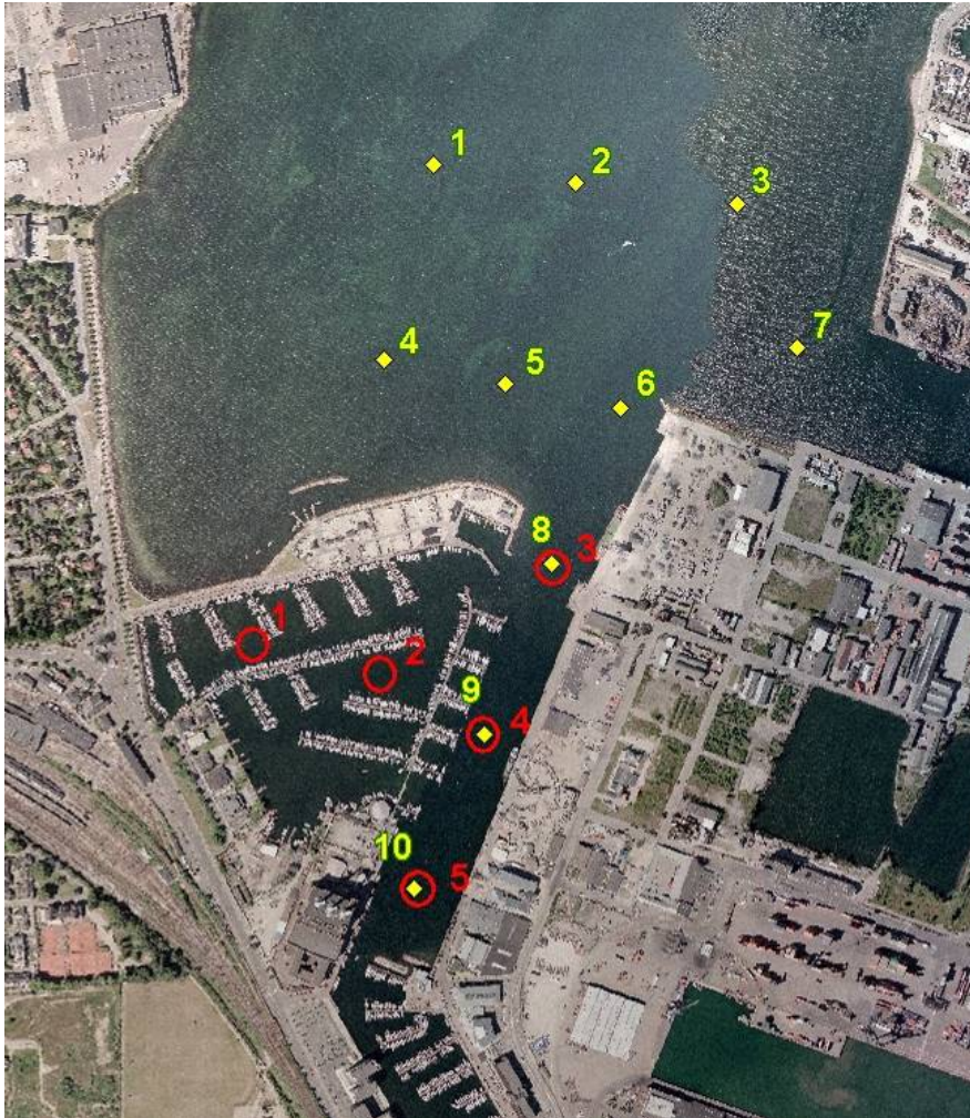
Figur 9.37 Udtagningssteder for sedimentprøver (røde cirkler) i Svanemøllehavnen.
