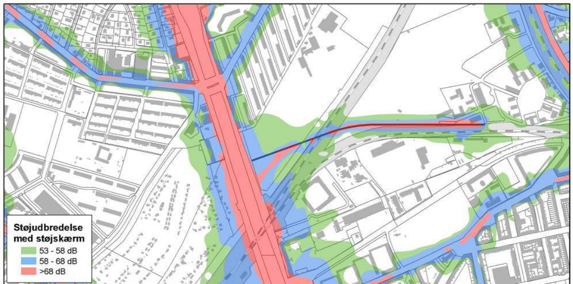
Figur 12.3 A Støjudbredelse i korridor omkring Nordhavnsvej som Vejforslag A1. Trafikstøjen er beregnet i 1,5 meters højde over terræn. Scenario med en udbygning 600.000 etagemeter på Nordhavn og 170.000 etagemeter ved Marmormolen. Der forudsat en niveaufri tilslutning med nordvendte ramper ved Helsingørsmotorvejen (Forslag I)
