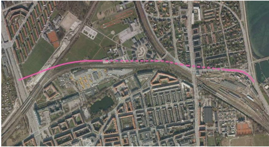
Figur 7.4 Linieføring for Vejforslag A1-4. Passagen under Nordbanen/Kystbane og Strandvejen udføres som en boret tunnel. Vejstrækning i tunnel er stiplede, vejstrækning i terræn er fuldt optrukket.
