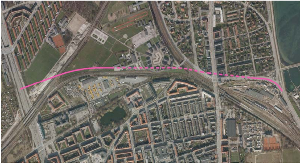
Figur 5.5 Linieføring for Vejforslag A1-4. Vejstrækning i tunnel er stiplet, vejstrækning i terræn er fuldt optrukket.
