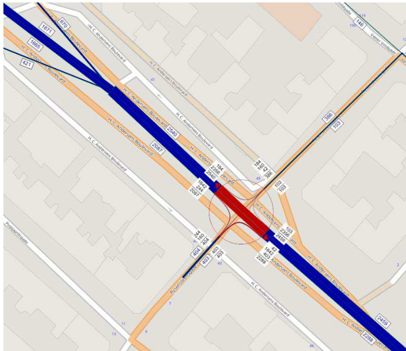
Figur 62 Figuren viser antallet af køretøjer i krydset H. C. Andersens Boulevard / Rysensteens-gade i morgenspidstimen (kl. 8:00-9:00).
