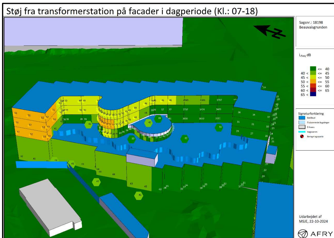
figur 4-8 Støj fra Transformerstation – Facadestøjskort
