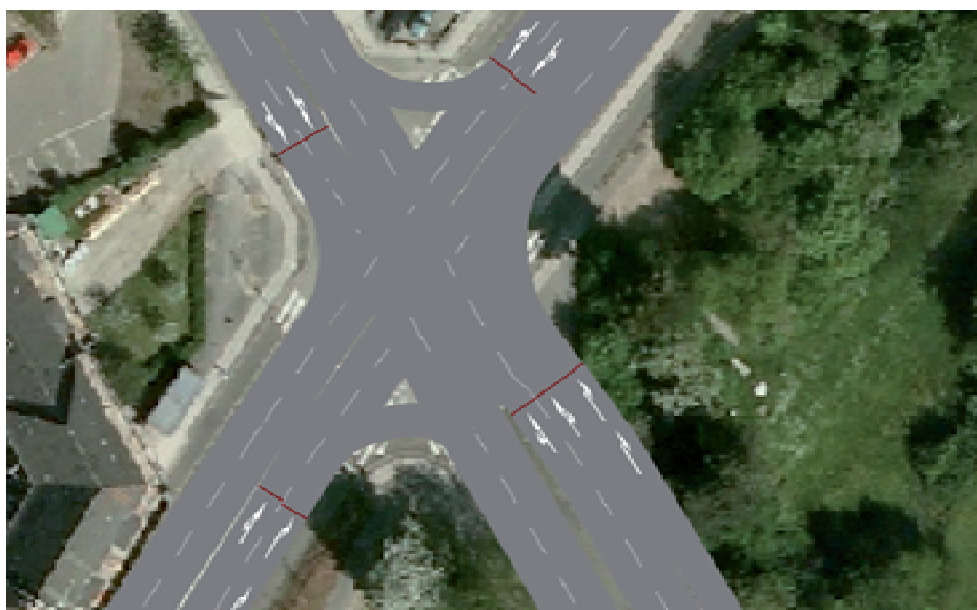
Figur 3.16 Krydset Jernbane Allé - Grøndals Parkvej med busbane.
