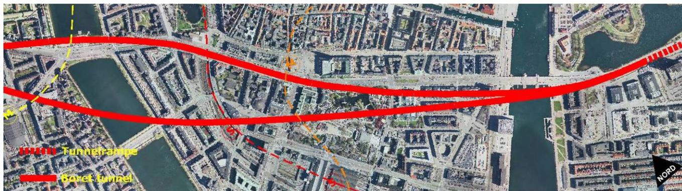
Figur 10: Ideskitse for mulige linjeføringer for en boret tunnel, der forbinder Bispeengbuen og Amager Boulevard. Hvis der skal etableres tilslutning til sidegaderne, skal tunnelen for en del af strækningen følge H C Andersens eksisterende linjeføring.
