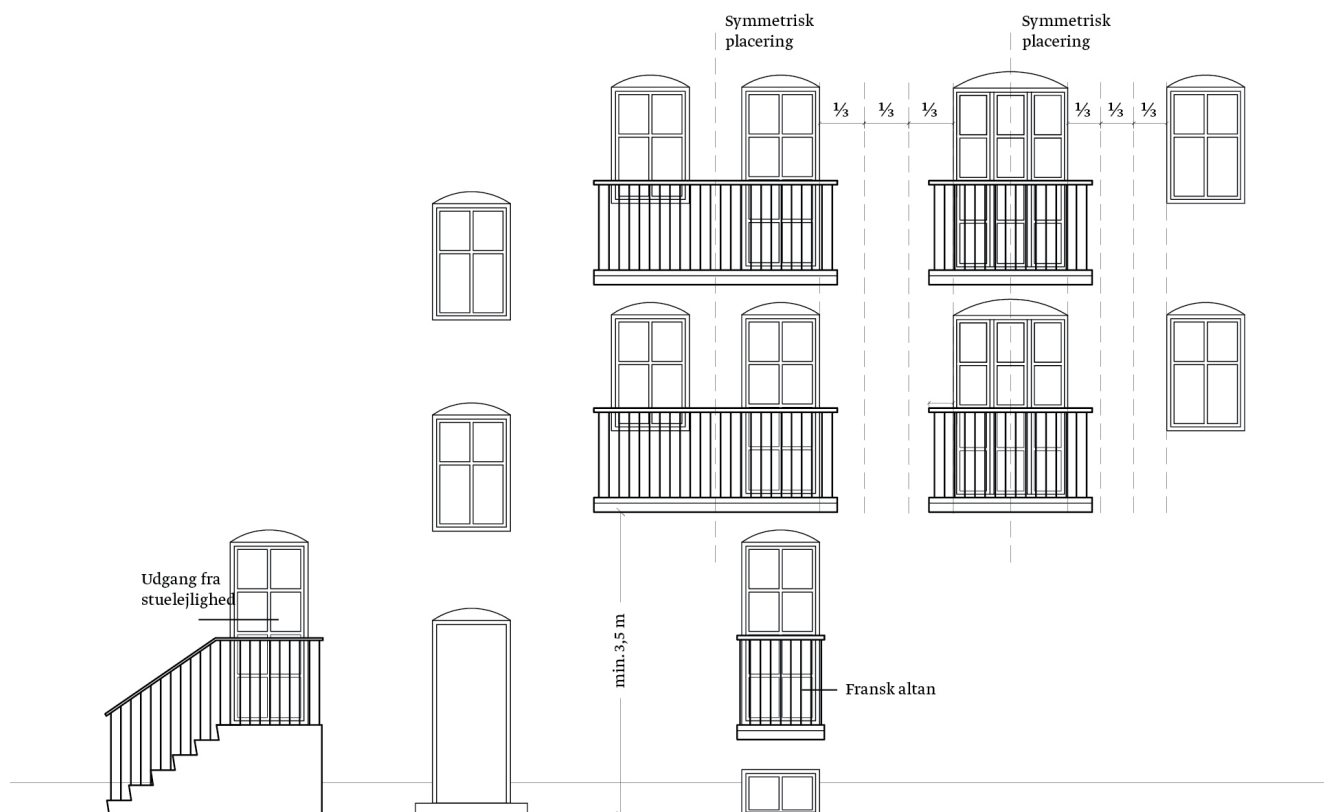
Principtegning 1. Principtegning, der viser afstandskrav mod terræn og mellem vinduer, hvordan en altan skal placeres symmetrisk i forhold til vinduerne og mulighed for etablering af fransk altan i den nederste etage eller skabe adgang til gården via en trappe.
