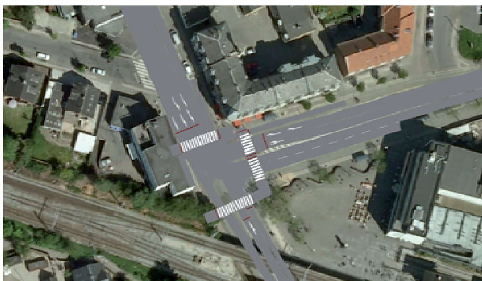
Figur 3.12 Krydset Jernbane Allé - Vanløse Alle med busbaner.
