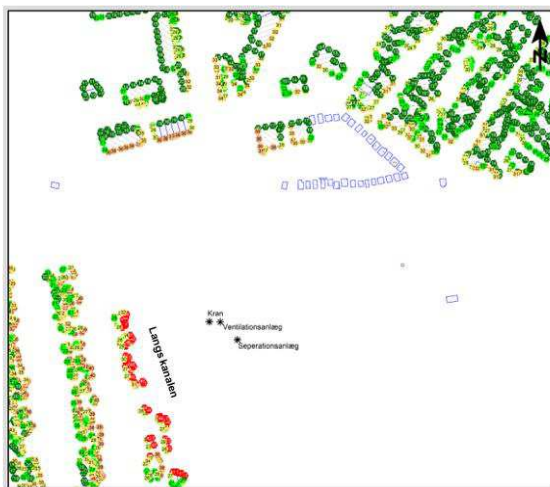
Figur 9.24: Støj fra anlægsarbejder i byggefase 6b for byggepladsen ved Enghave Kanal, ved drift af tunnelarbejdspladsen (slurry-metoden) om natten forudsat maksimal støjdæmpning af kran og separationsanlæg. Tunnelering med EPB viser samme støjubredelse. Haveforeningen Musikbyen er ikke godkendt til overnatning.
