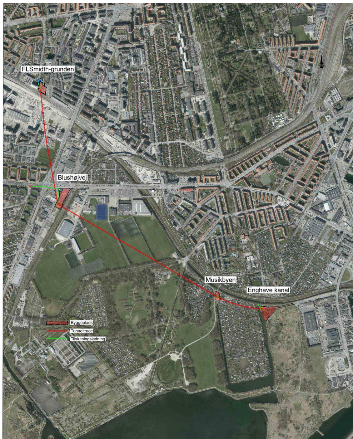
Figur 2.1. Skybrudstunnelens forløb mellem byggepladserne.
