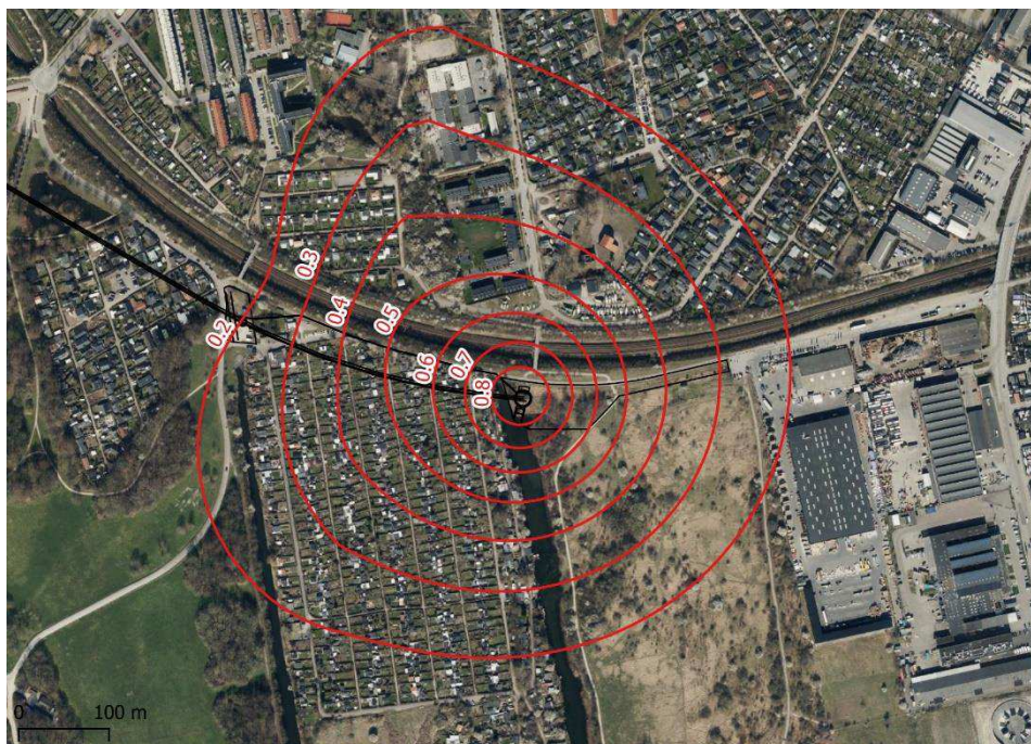
Figur 17.12 Scenarie 2. Grundvandssænkning i toppen af kalken (m), Enghave Kanal.
