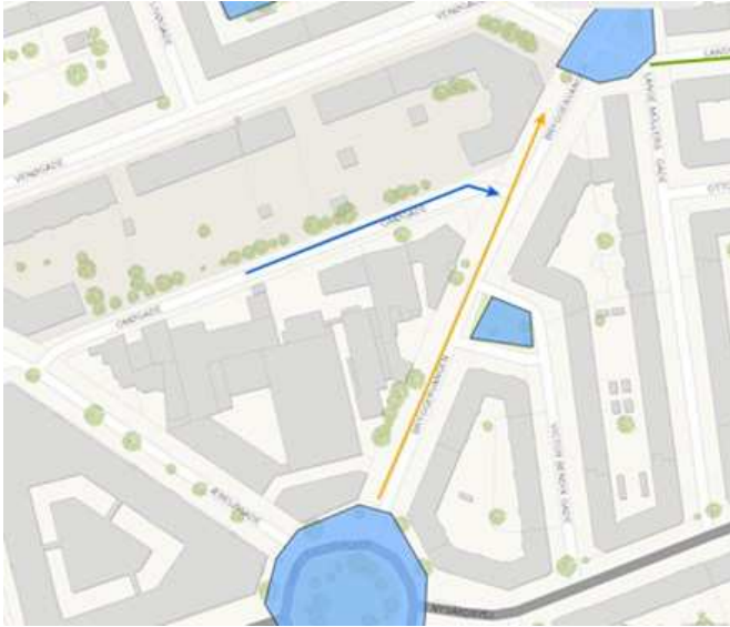
Figur 1: Kortet viser at vandet på Omøgade, efter en terrænregulering, vil løbe videre til Bryggervangen hvor det vil indgå i det skybrudssystem som er etableret der.
