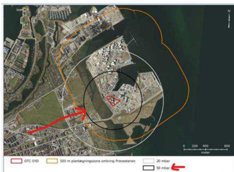
Figur 6-11 Afstand til 50 mbar og 20 mbar trykkurver (scenario: gassky efter brud på rørlødnings)
