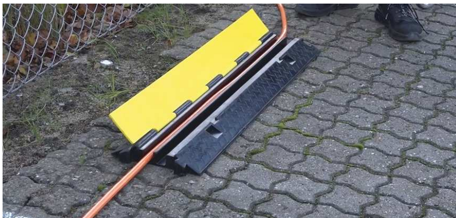
Figur 1 Eksempel på kabelbro/bakke
