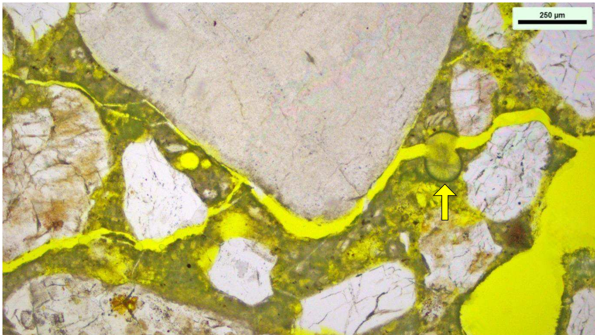
Figur 17. Prøve 3 – Mikrofoto af revnesystem, som bærer præg af at være dannet tidligt efter støbning af betonen, men som ligeledes bærer præg af at fortsat at være aktiv da der optræder luftpore med udfældninger af ettringit som er revet fra hinanden (gul pil) (foto taget ved planpolariseret belysning).
