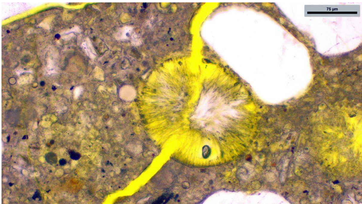
Figur 16. Prøve 2 – Mikrofoto af revne som passerer igennem en luftpore, hvor der i forvejen er udfældet sulfatmineralet ettringit, hvilket tyder på en senere dannet revne ( foto taget ved planpolariseret belysning ).
