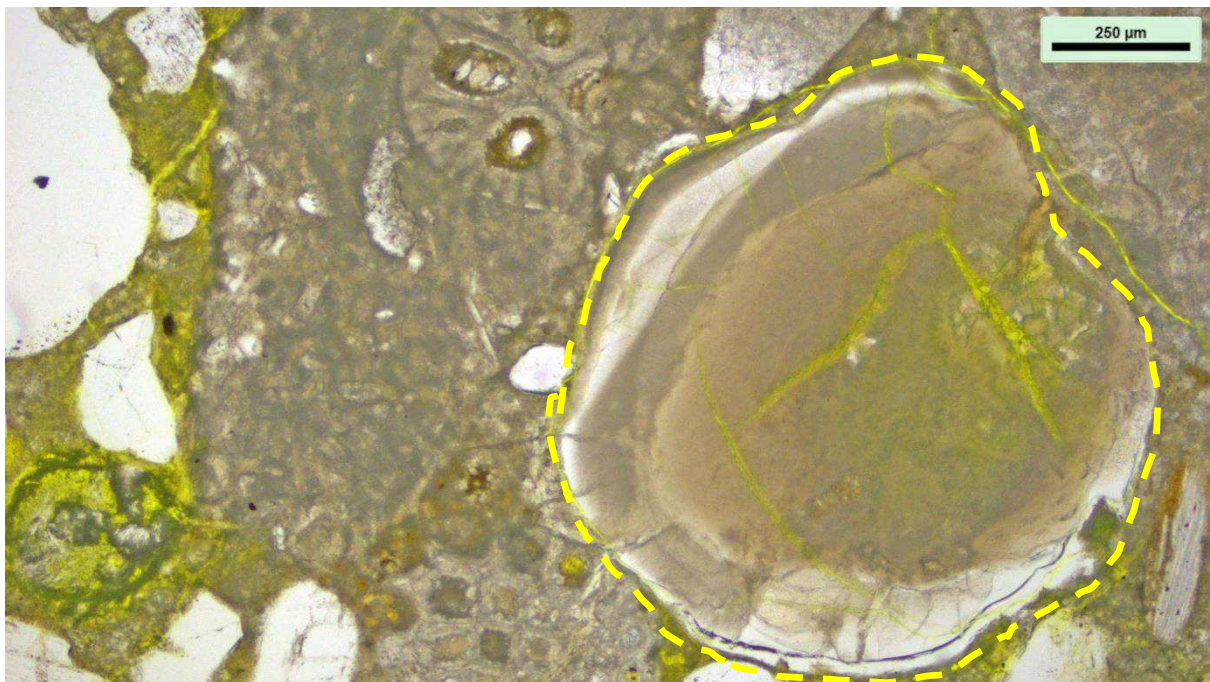
Figur 19. Prøve 4 – Mikrofoto af sandkorn af opalflint, som har været under alkalikiselreaktion og udfyldt en luftpore med alkalikiselgel (gul cirkel) (foto taget ved planpolariseret belysning).
