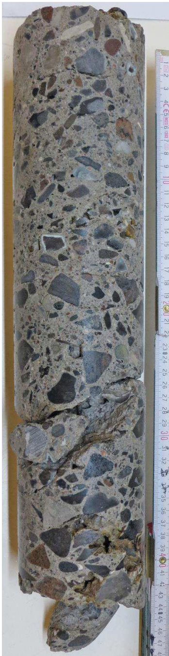
Figur 7. Prøve 4 - Foto af borekernen med boresiden orienteret op. Størstedelen af borekernen er imprægneret med epoxy og gennemskåret aksialt.
