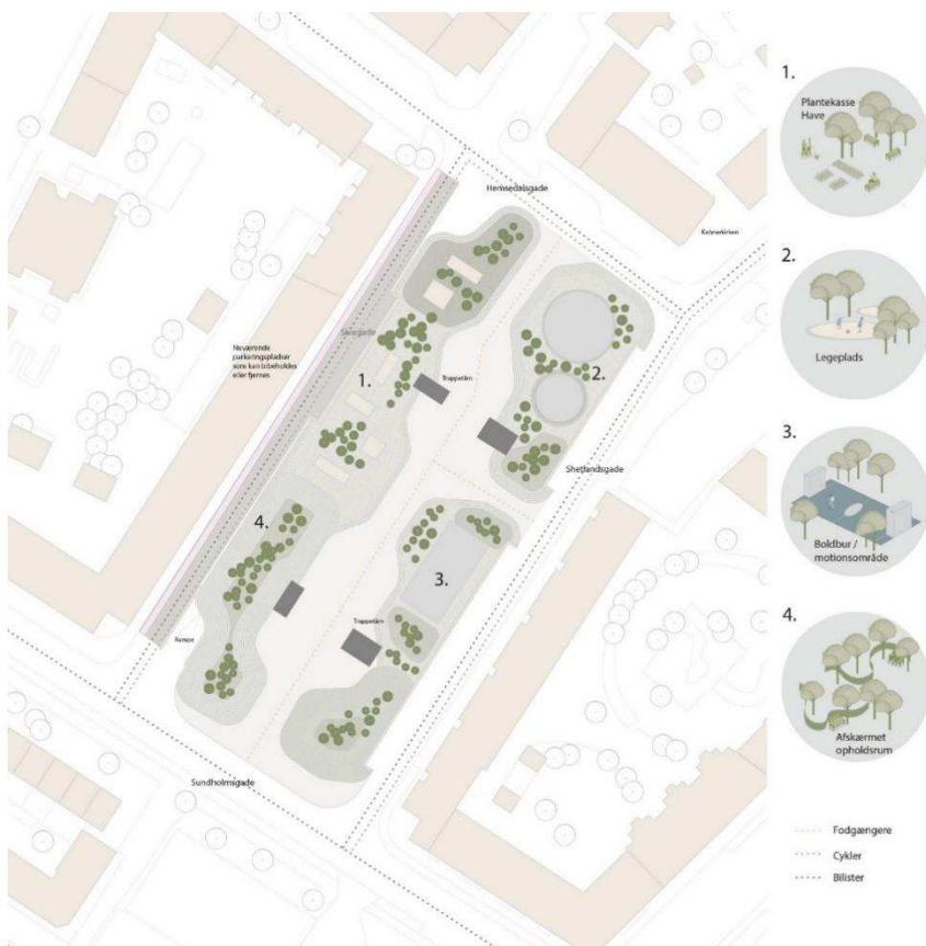
Forslag 2: Skotlands Plads – design for 0,5m jorddække over P-Kældres konstruktion med lokale forhøjninger på 1 m over terræn til plantning af træer.
