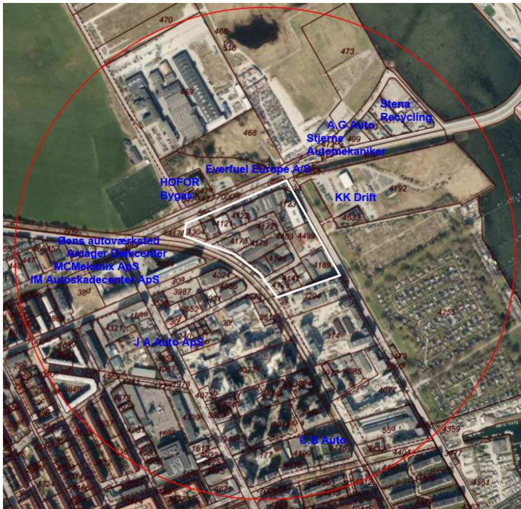
Figur 7-9: Situationsplan med kortudsnit over det undersøgte område og virksomheder, der er placeret indenfor en radius af 400 m fra projektområdet. Området er omkranset af den røde cirkel og projektområdet er markeret med hvidt.
