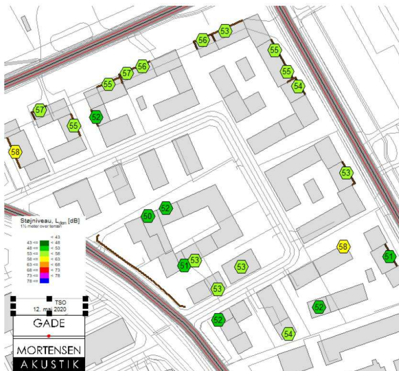
Figur 7-6. Støjniveauer på tagterrasser med 1,8 m høje støjskærme.
