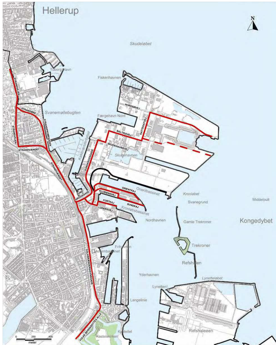
Figur 25 Projektets fastlagte influensvejnet. I den øvre del af kortet ses vejen til oplags-/karteringspladsen, som forløber fra Kattegatvej. Der anlægges en ny vej til den nye krydstogtterminal, som er vist som stipleet på figuren.
