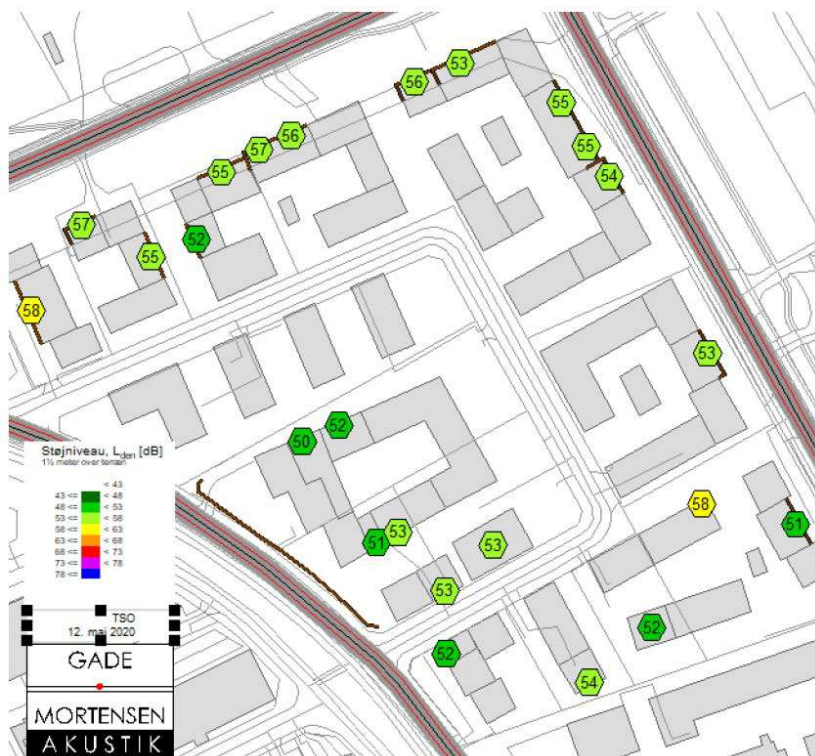
Figur 7-6. Støjniveauer på tagterrasser med 1,8 m høje støjskærme.
