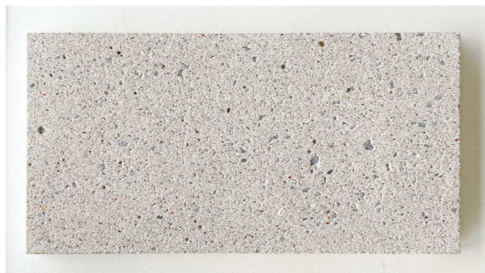
Materialeprøve - Tekstilsærket betonplade med varieret tilslag
