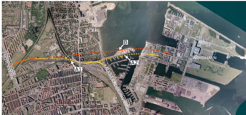
Figur 3: Vejforslag A (gravet tunnel) og vejforslag B (boret tunnel).Vejforslag A med tilslutning til Strandvænget - Kalkbrænderihavnsvej kan etapedeles.
