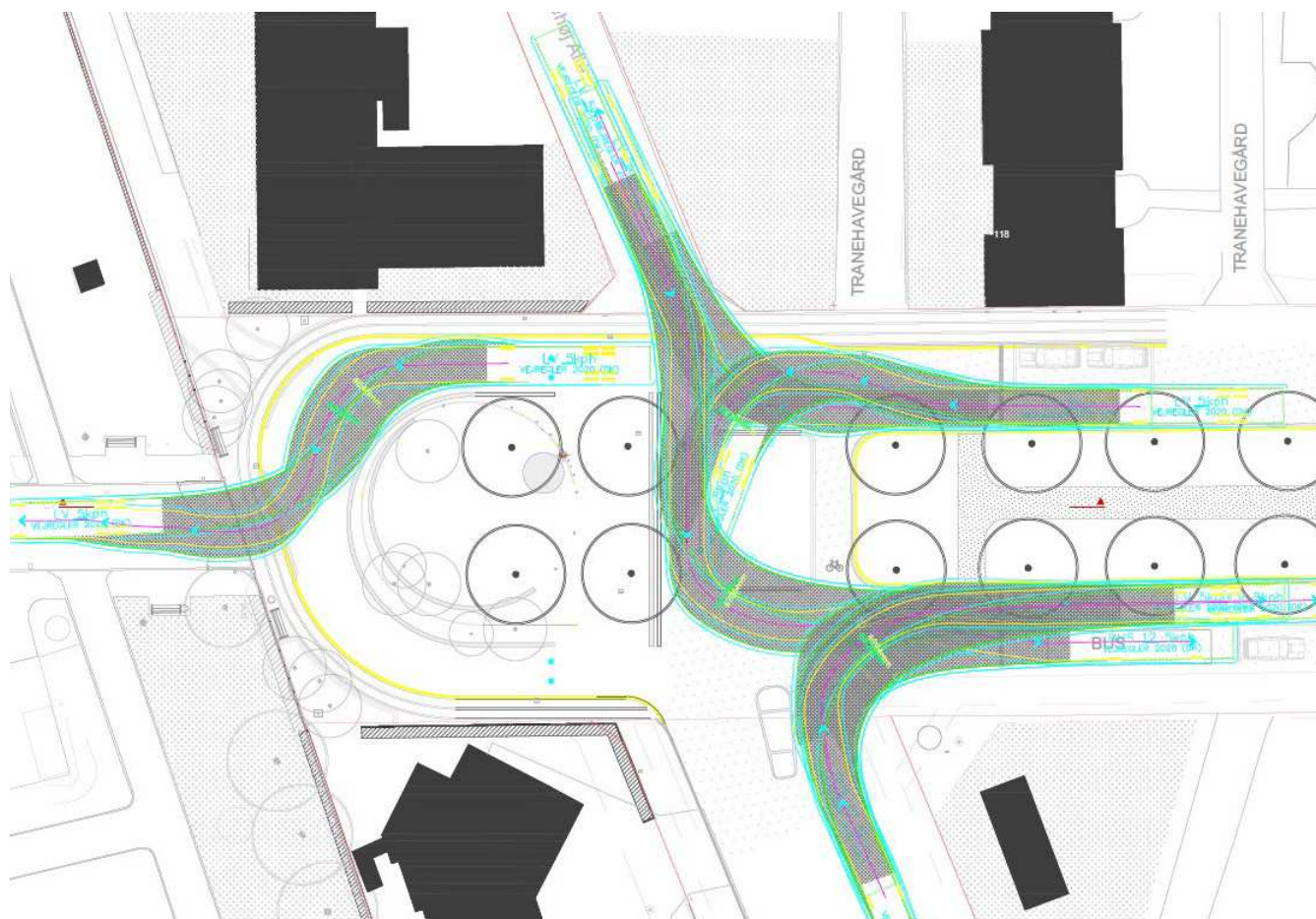
Diagram over Projektforslagets trafik afvikling for tunge køretøjer. Nuværende hjørne rettes til med fremtidig R: 7 m så busser ikke kører på fortov.
